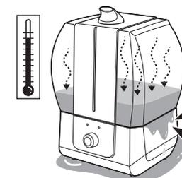
特に日光が差し込む窓際、暖房器具の近くやエアコンの風が直接本体に当たるような場所を避けて設置してください。やむを得ず寒暖差が大きい部屋に設置する場合は、タンクに液剤を多く入れた（空気の量を少なくした）状態でご使用頂くことで、空気の膨張による液剤漏れを防ぐことができます。
